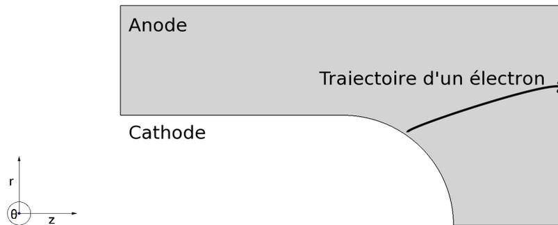
FIGURE 6.1 – Schéma d'une diode à cathode hémisphérique.
