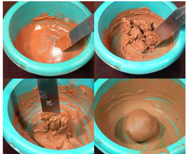
Fig. 5 – Une boue d'argile dispersée passe de l'état liquide à l'état plastique lorsqu'une pincée de sel est ajoutée : la suspension concentrée coagule.
