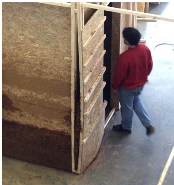
Fig. 12 – La terre à pisé non modifiée est coulée, avec beaucoup d'eau, dans la structure en bois, qui se déforme totalement sous l'action des poussées horizontales. D'après Le Tiec (2005).
