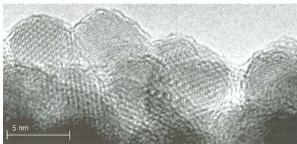
Fig. 135 – Image MET Haute Résolution de 6-line ferrihydrite mettant en évidence sa nature cristalline. D'après Janney et al. (2009).
