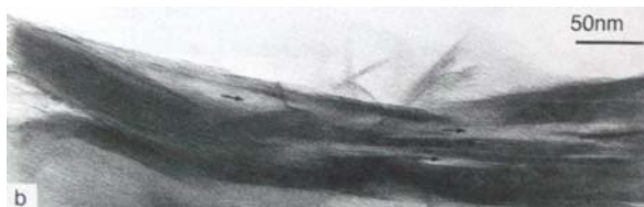
Fig. 48 – Une montmorillonite calcique dans une solution diluée ( 10^{-3} M CaCl 2 ) forme des paquets de 50 feuillets environ. D'après Tessier (1990).
