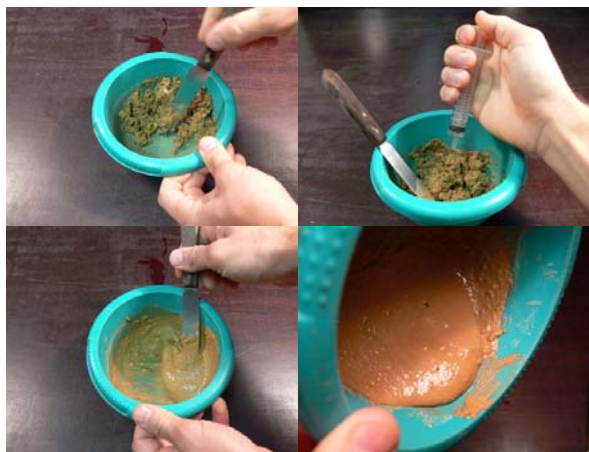
Fig. 3 – Avec seulement 0,1% d'hydroxyde de sodium, cette terre naturelle de Bretagne se liquéfie totalement en passant de pH 5 à pH 7.
