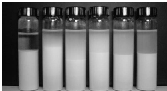
Fig. 72 – Suspensions de kaolinite sans sel avec des quantités croissantes de nanoparticules de silice. De gauche à droite : 0, 1, 3, 5, 7, and 10% vol. D'après Baird et Walz (2006).
