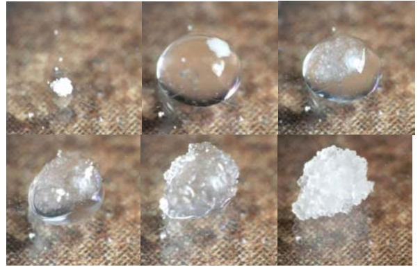
Fig. 22 – Une goutte d'eau est déposée sur un minuscule échantillon de polyacrylate de sodium en poudre. Instantanément, la poudre gonfle au sein de la goutte, au point finalement de dépasser ses frontières. Images tirées de la vidéo : www.youtube.com/watch?v=pxlJdzjzQes
