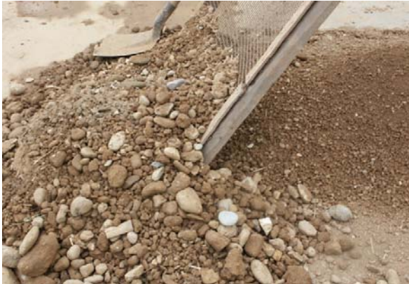
Fig. 19 – La terre est tamisée. Le passant constitue la partie de la terre qui est passée à travers le tamis (à droite). Le refus est constitué des plus gros granulats qui ne sont pas passés. De manière complètement contre-intuitive, c'est ce refus, habituellement jeté, qui constitue le matériau de construction approprié pour le projet d'habitat léger. D'après Le Tiec (2005) .
