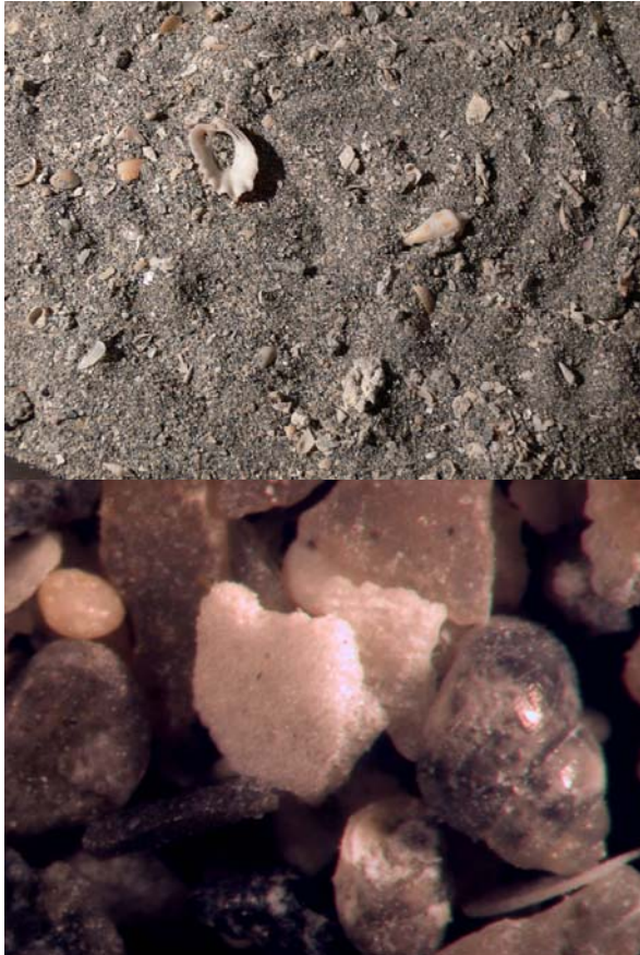
Fig. 61 – Haut : 1 er échantillon de sable envoyé par Shigeru Ban. Bas : en gros plan, il apparaît que ce sable marin est essentiellement constitué de débris de coquillages.
