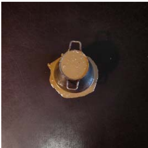
Fig. 40 – Un essai d'étalement (cône d'Abrams) consiste à placer le mélange dans un moule métallique qui est retiré. L'étalement du matériau est ensuite mesuré.
