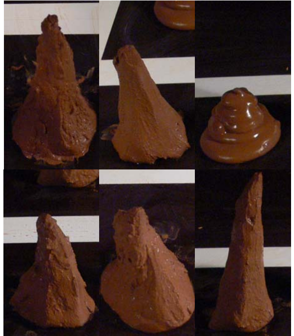
Fig. 4 – Comparaison de l'effet du pH sur la viscosité d'une boue d'argile sans sel (3 images du haut) et avec sel (3 images du bas). pH de gauche à droite : 5, 7 et 10. Sans sel, la viscosité diminue lorsque le pH augmente de 5 à 10. Avec sel, les écarts de viscosité sont plus faibles, mais la tendance opposée est observée. Le sel est un inverseur de tendance : il réduit les interactions répulsives entre surfaces de même charge et réduit les interactions attractives entre surfaces de charges opposées.
