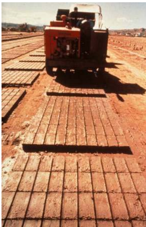
Fig. 20 – Aux Etats-Unis, cette machine, appelée pondeuse à adobes, produit des milliers de briques par jour. La principale contrainte pour les unités de production industrielle est la vaste zone de stockage des briques, qui séchent en une semaine environ, avant d'être palettisées. Photo : Christine Bastin & Jacques Evrard.
