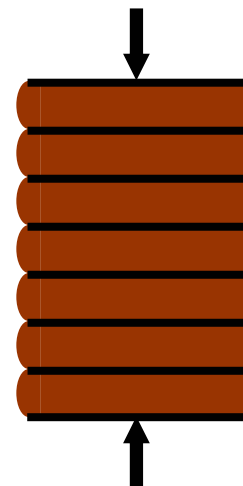
Fig. 100 – Représentation schématique de la compression d'une éprouvette constituée d'une superposition d'échantillons de terre de faible élancement entre lesquels sont placés des matériaux créant du frottement.
