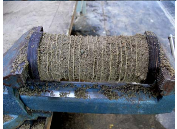
Fig. 117 – Eprouvette en sable armé précontrainte dans un étai. La compression permet d'augmenter la résistance à la flexion et au cisaillement.
