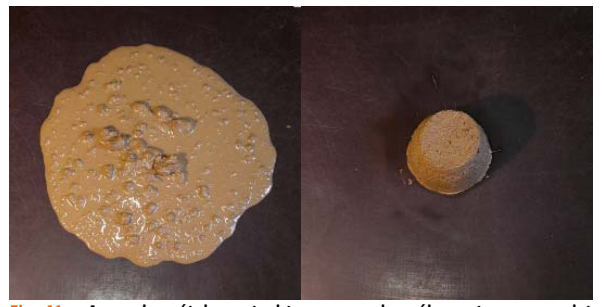
Fig. 41 – A gauche : étalement obtenu pour le mélange terre, granulats, ciment, eau et superplastifiant. A droite : étalement obtenu pour le même matériau sans superplastifiant.
