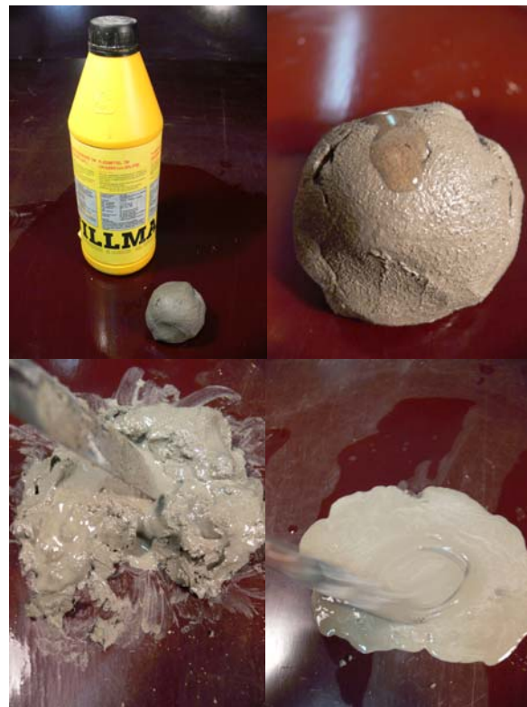
Fig. 38 – Une goutte de superplastifiant est déposée sur une boule de ciment plastique. Le malaxage fluidifie totalement et instantanément la pâte.
