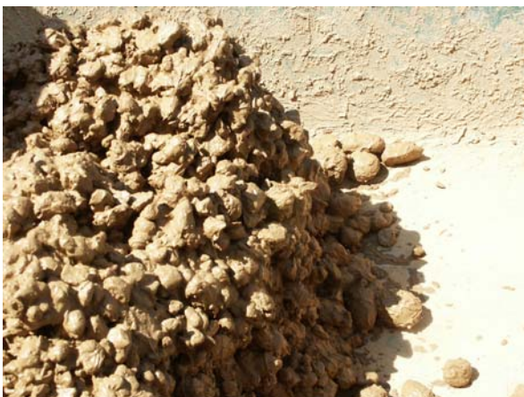
Fig. 23 – Contrairement à un liquide qui adopte une surface horizontale et à un tas de sable qui adopte une pente de 30° environ, ce matériau présente une paroi verticale, signe qu'il n'exerce pas de poussées horizontales. D'après Le Tiec (2005).
