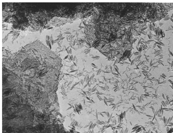
Fig. 88 – pH initial 3 - 20% oxyde de fer – pH 3. Ohtsubo et al. (1991).
