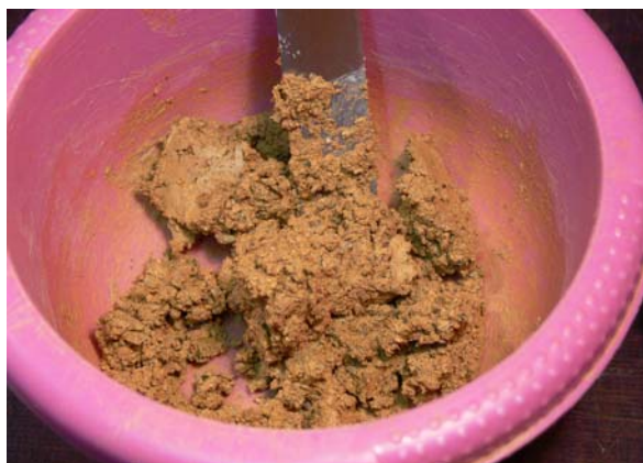
Fig. 13 – Boue de terre à pisé terre de Bretagne (France) tamisée à 200 microns à pH naturel (5).
