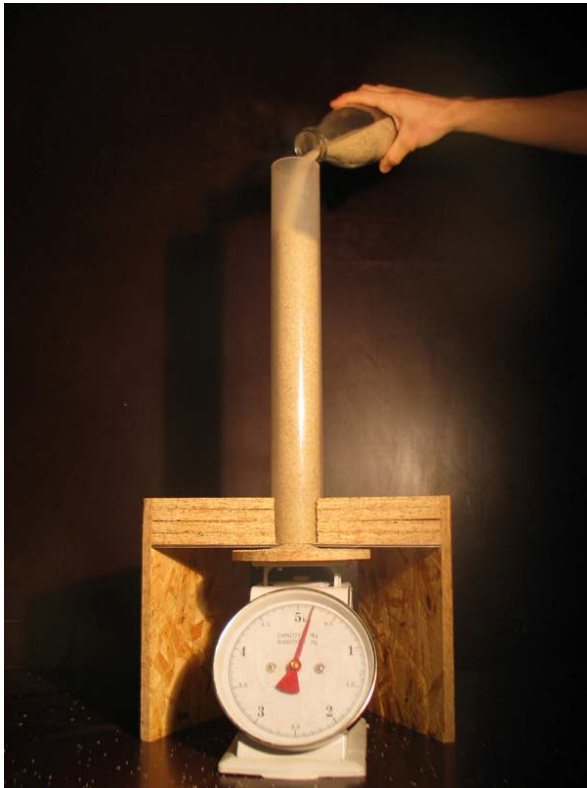
Fig. 49 – Le poids des grains est redirigé dans les parois du tube et n'atteint pas le plateau de la balance.
