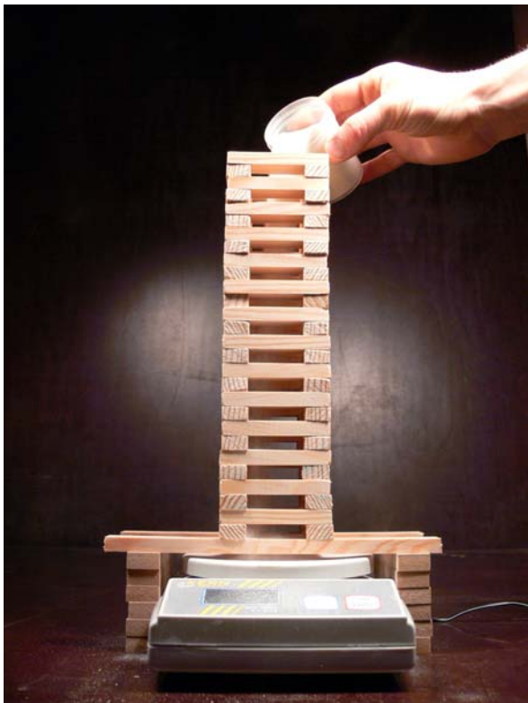
Fig. 50 – Expérience de la balance magique reproduite avec la structure en bois ajourée. En haut à droite : lorsqu'un petit volume de sable est versé, la balance indique 76 g. En bas à droite : lorsque la totalité de la structure est remplie, la balance indique 98 g.
