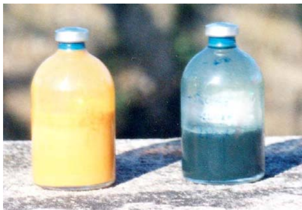
Fig. 157 – Bioréduction de lépidocrocite, oxyde de fer ferrique de couleur orange (à gauche), en rouilles vertes (à droite) par les bactéries Shewanella putrefaciens . D'après Jorand et Ruby (2006).
