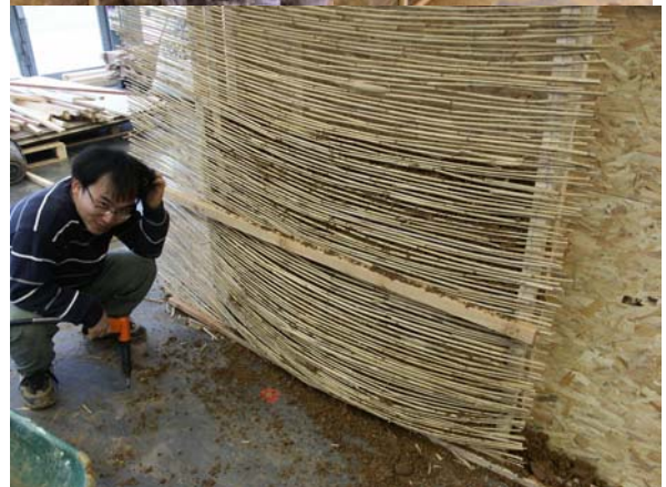
Fig. 16 – La terre est versée dans un état encore plus sec, derrière une canisse de roseau. La poussée horizontale est toujours trop grande. D'après Le Tiec (2005).
