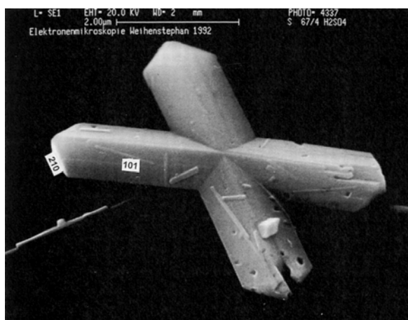
Fig. 93 – Macle formée de l'association de deux cristaux aciculaires délimités par des faces [101] et [210]. D'après Cornell et Schwertmann (2003).
