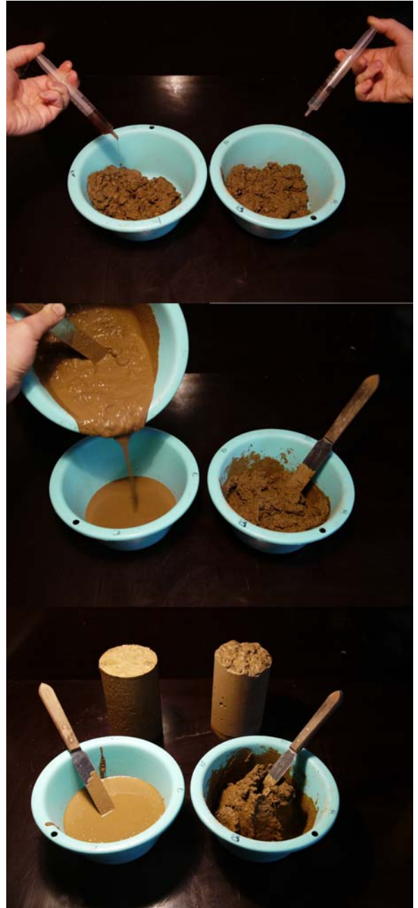
Fig. 39 – A gauche : quelques gouttes d'une solution concentrée de molécules peignes sont ajoutées à un mélange de terre, granulats, ciment et eau. A droite : un volume d'eau équivalent est ajouté au même mélange. La différence de viscosité entre les deux matériaux est impressionnante : le superplastifiant transforme le matériau en véritable béton autonivelant. Les deux matériaux ont été moulés et décoffrés le lendemain. Au séchage, les éprouvettes ne fissurent pas.
