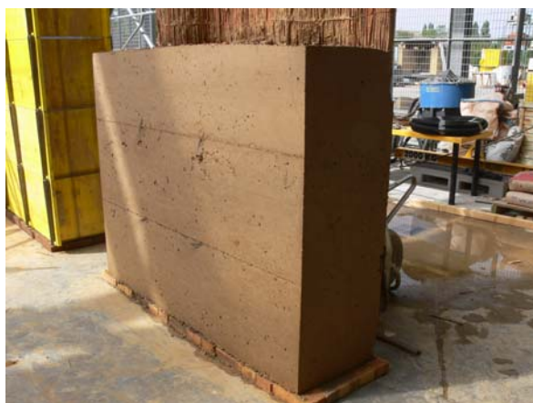
Fig. 6 – Mur en béton d'argile, mis en œuvre à l'état liquide, vibré et coffré, réalisé aux Grands Ateliers par l'entreprise Caracol.
