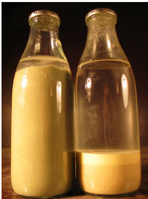
Fig. 26 – Différence de gonflement dans l'eau entre une kaolinite (à droite) et une argile gonflante de type smectite (à gauche).
