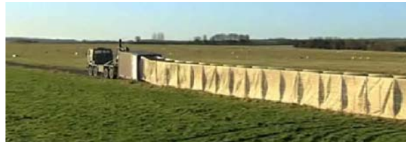
Fig. 76 – 330 m de big-bag sont déployés en 1 minute. Photo : HESCO bastion, www.hesco.com/raid
