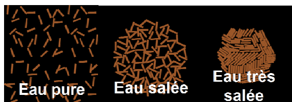
Fig. 39 - 3 états de dispersion correspondant aux 3 images de la figure précédente. Gros plan sur les cases pH 10 - 0 g NaCl, pH 10 - 1 g NaCl, pH 10 - 10 g NaCl du tableau de la figure précédente.
