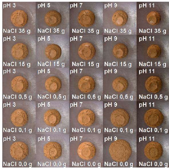
Fig. 9 – Essais d'étalements (cône d'Abrams) d'échantillons de terre à pisé du Dauphiné pour différents pH et forces ioniques.
