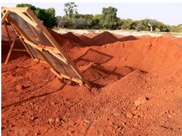
Fig. 10 – Les agrégats de kaolinite et d'oxydes de fer peuvent prendre une structure de pseudo-sable, ici utilisés pour la confection de Blocs de Terre Comprimée, au Mali.
