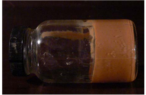
Fig. 31 – Une boue d'argile dispersée a été coulée à l'état liquide. Quelques jours plus tard, la boue a gélifié et un seuil d'écoulement important est apparu.
