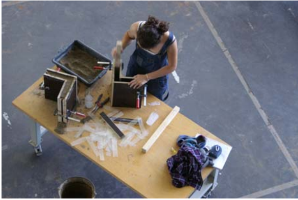
Fig. 102 – Compactage du sable dans le coffrage à l'aide d'un mini psoir.
