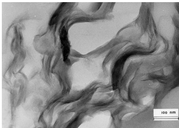
Fig. 45 – Image MET de smectite. A cette échelle, on commence à discerner les feuillets. Photo : Christian Clinard et Henri Van Damme.
