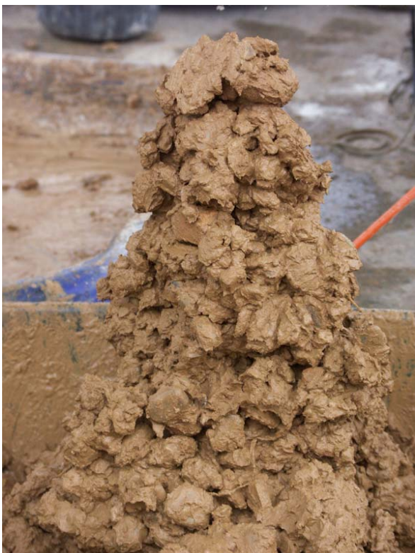
Fig. 24 – Malgré la grande imbibition du liant argileux, le matériau ne s'étale pas grâce aux interactions de contact entre les granulats. C'est un véritable béton d'argile à affaissement nul. D'après Le Tiec (2005).
