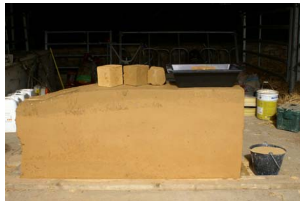
Fig. 4 – La stabilisation au ciment permet de décoffrer le mur rapidement. Une fois sec, le matériau ne présente aucune fissuration.
