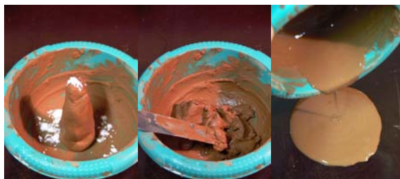
Fig. 15 - La boue d'argile de la Fig. 5, préalablement dispersée par ajout de soude caustique, puis refloculée par ajout de lait de chaux, est à nouveau dispersée par ajout d'hexamétaphosphate de sodium. Une partie des anions hexamétaphosphate complexent l'ion calcium présent en solution tandis que l'autre partie se fixe chimiquement sur les bords, augmentant davantage la charge négative des bords.
