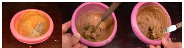
Fig. 6 – Pour les mêmes raisons, une petite quantité de ciment provoque la coagulation de l'argile d'une terre naturelle de Bretagne, préalablement dispersée par ajout de soude caustique. La stabilisation à la chaux ou au ciment est donc incompatible avec la liquéfaction par ajout d'une base.
