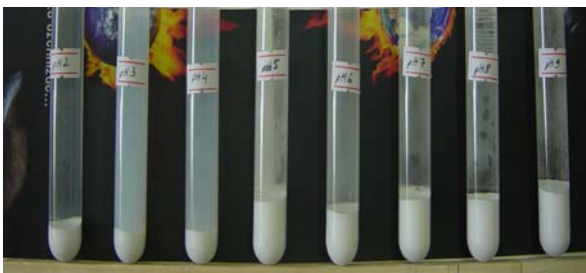
Fig. 37 – Représentation schématique des hauteurs de sédimentation obtenues pour une série de suspension d'alumine à différents pH. D'après Gürel et Altun, 2009.
