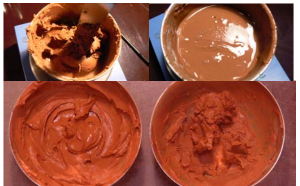
Fig. 7 – Haut : l'argile de la terre à pisé du Dauphiné coagule par ajout d'acide (à gauche) et se liquéfie par ajout d'une base (à droite). Bas : une terre rouge riche en oxydes de fer adopte un comportement parfaitement opposé : l'ajout d'acide (à gauche) liquéfie la terre, l'ajout de base (à droite) provoque une coagulation.
