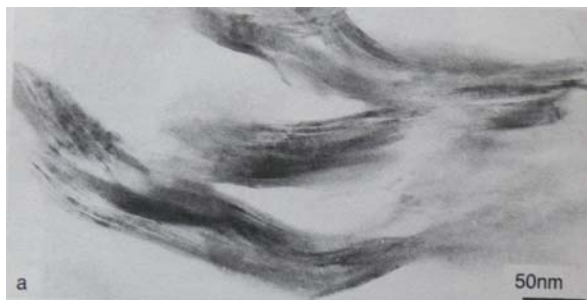
Fig. 47 – Dans une eau fortement salée (1 M NaCl), une montmorillonite sodique forme des paquets de 40 feuillets empilés environ. D'après Tessier (1990).
