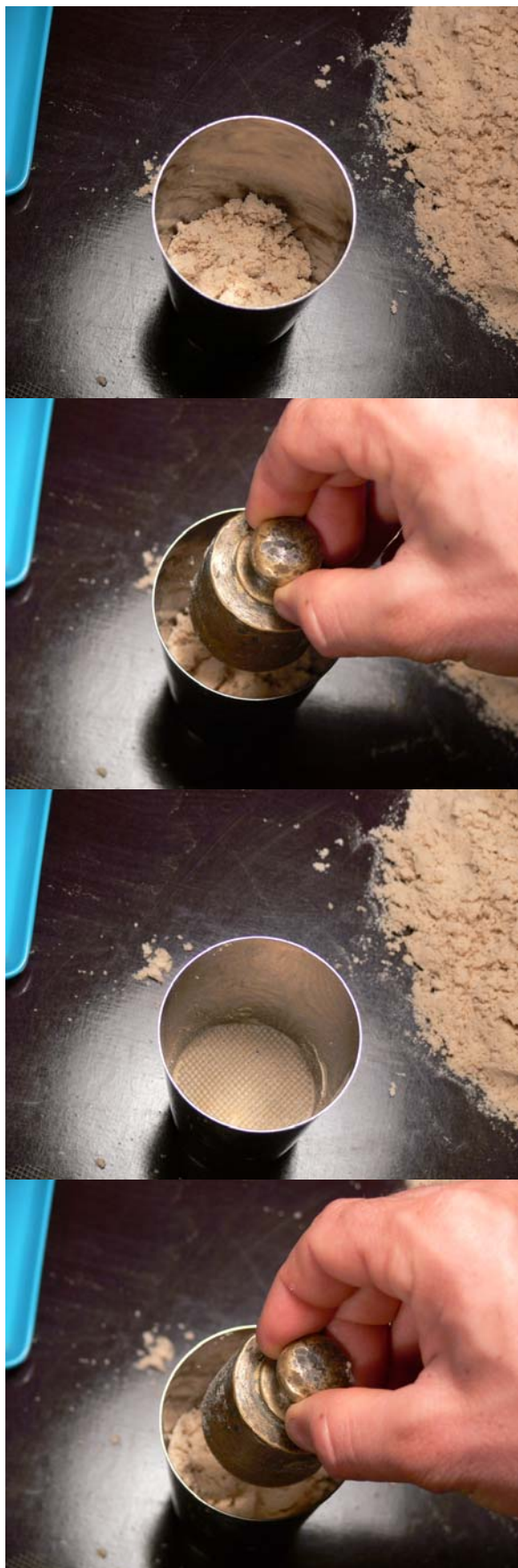
Fig. 101 – De fines couches de sable sont compactées. Des armatures métalliques sont placées entre chaque couche (image du haut page ci-contre). Le pâtre de sable obtenu supporte aisément le poids d'un homme.
