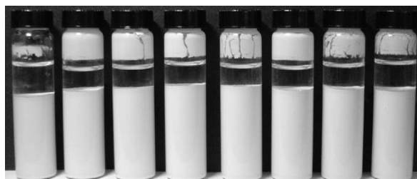
Fig. 71 – Suspensions de kaolinite sédimentées en l'absence de nanosphères de silice. La concentration en sel varie de 0 mM (gauche) à 700 mM (droite). D'après Baird et Walz (2006).
