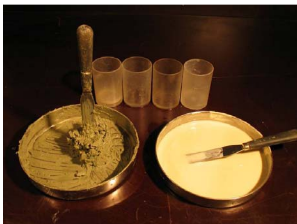
Fig. 27 – Différence de viscosité entre une boue de kaolinite (à droite) et une boue de smectite (à gauche) pour un même ratio solide/liquide.
