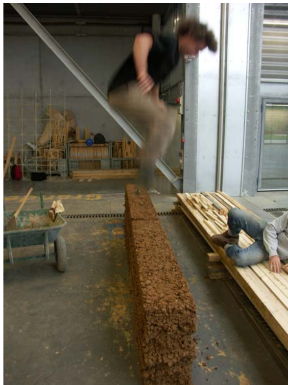
Fig. 57 – Le mur, coulé, est immédiatement décoffré et présente une résistance étonnante.
