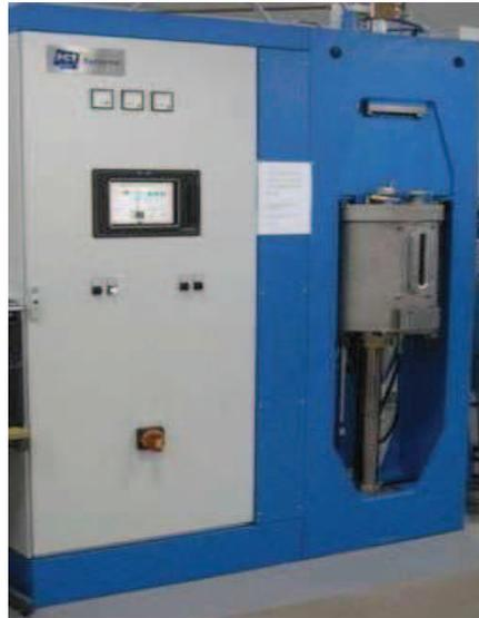
*Figure 2-13* Description du dispositif SPS
