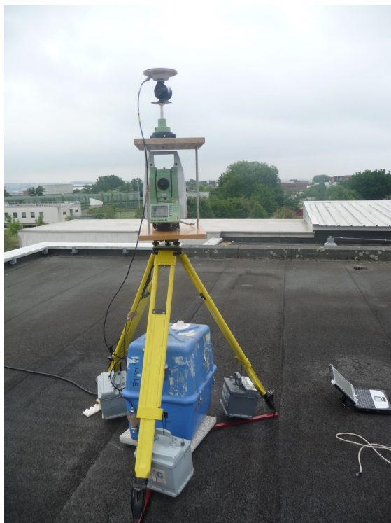
FIGURE 2.7 – Photos des adaptateurs entre antenne GPS et tachéomètre
