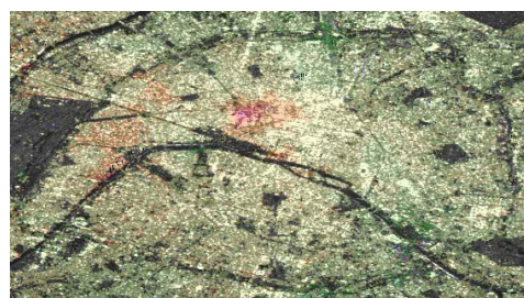
FIGURE 2. Déformation de Paris détectée par InSAR [Mimouni 2008]
