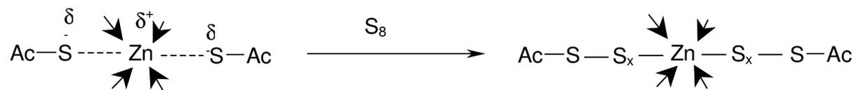
L'agent se fixe alors sur la chaîne macromoléculaire par arrachement d'un hydrogène en  $\alpha$  de la double liaison. De cette réaction on obtient des produits secondaires comme le ZnS et un dérivé sulfuré ; ces deux espèces vont pouvoir réagir ensemble pour régénérer l'agent actif de sulfuration.
