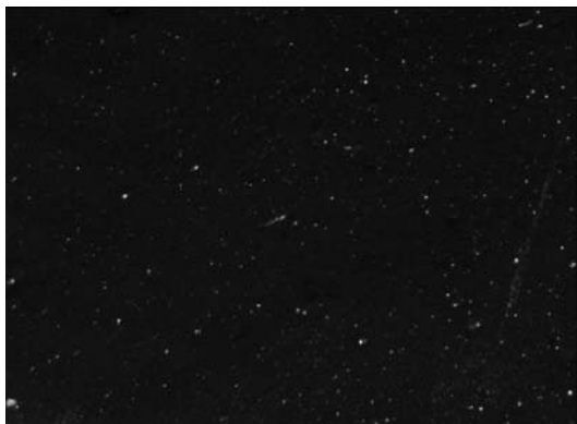
Figure IX-3 : Image prise au Dispergrader d'un échantillon de caoutchouc chargé avec de la silice bien dispersée.
