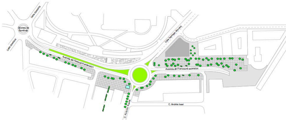
Figure 147 – Plan du quartier d'Ametzola, mettant en évidence l'opération de requalification de l'Avenue du Ferrocarril récemment couverte. L'emprise des nouveaux espaces arborisés est prégnante dans cette représentation. A la manière d'avant-postes, des alignements de verdure introduits au sein des avenues environnantes signalent aux piétons l'entrée prochaine dans un espace qui leur est dédié. © Bilbao Ria 2000. BR2000 n°9, juin 2004, p. 27.
