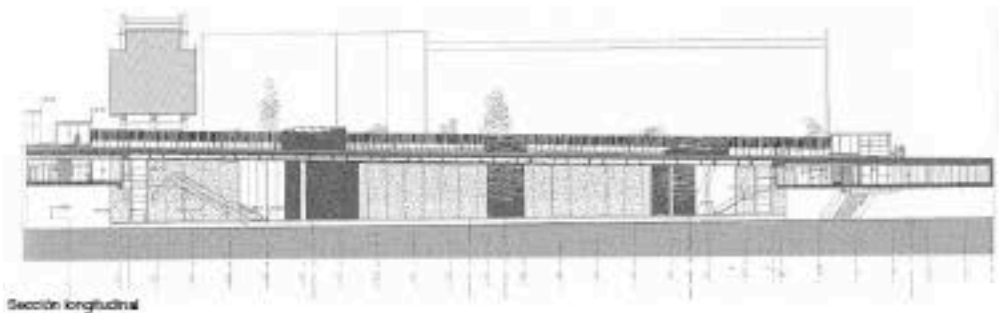
Figure 135 - Coupe longitudinale de la Gare de San Mamès mettant en évidence les diverses entrées. L'infrastructure est pour l'essentiel enterrée, libérant l'espace en surface pour d'autres usages. © Bilbao Ria 2000.
