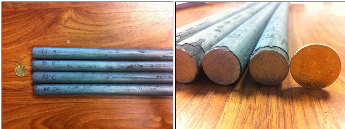
Figure 2-4 : Photographies des barres filées des échantillons A, B, C et D.
