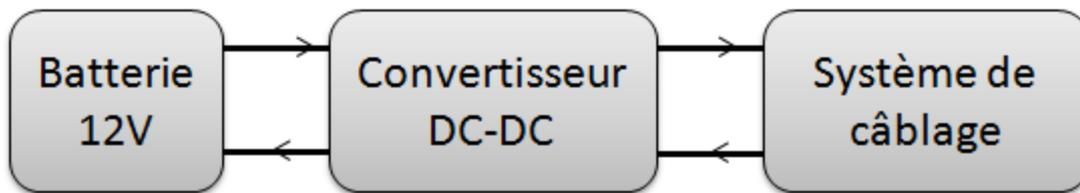
Figure III.10 – Association DC-DC et système de câblage
