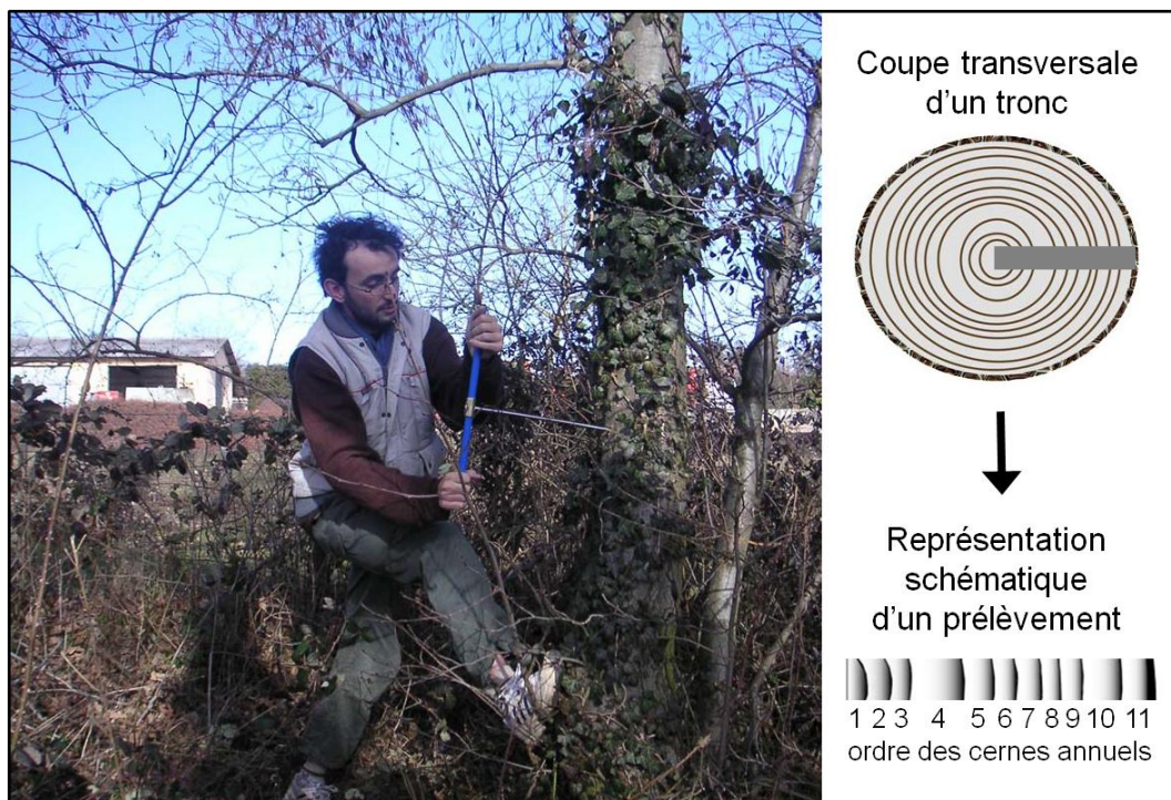
Figure 15 : prélèvement d'une carotte dendrochronologique à l'aide d'une tarière à bois
