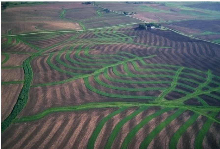
Figure 81 : exemple d'un système de noues et de bandes enherbées sur une parcelle agricole (Tim McCabe – USDA)
