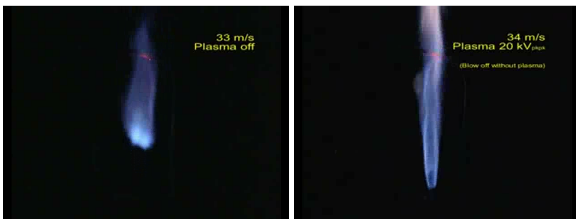
Figure 1.1 – Comportement d'une flamme de diffusion et ses limites de fonctionnement SANS puis AVEC assistance plasma. On remarquera l'augmentation de la vitesse de soufflage de près de 50 % [3].
