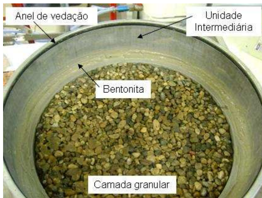
Figura 5.5 – Detalhe do interior da unidade intermediária.
