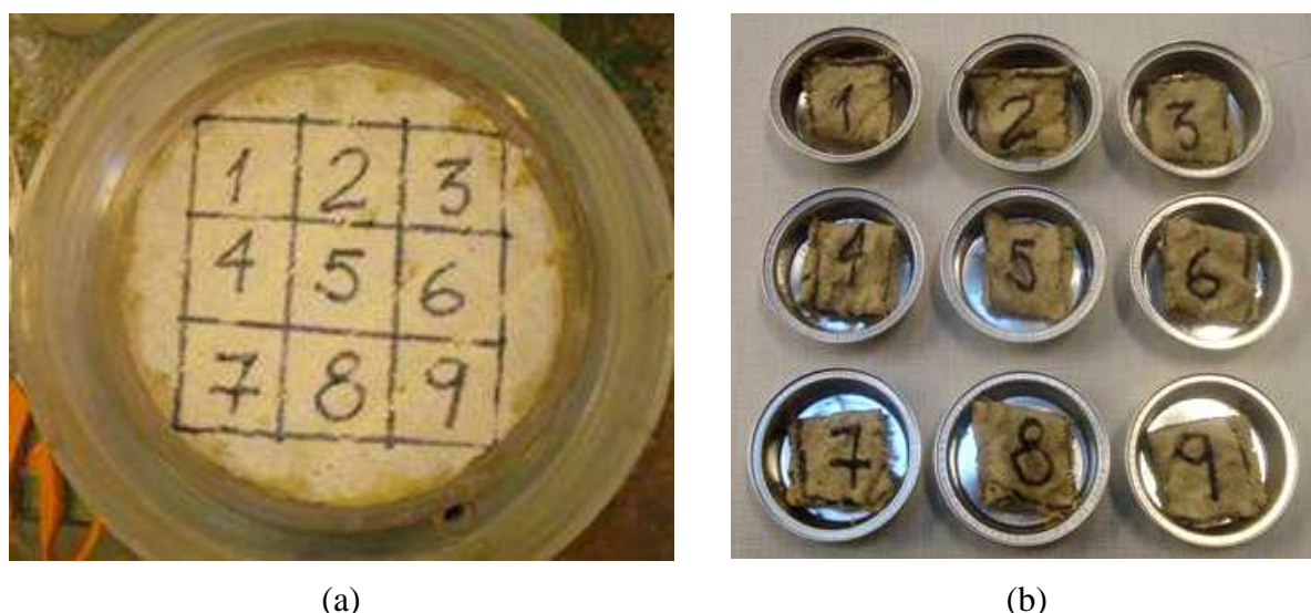
Figura 8.8 –Determinação da distribuição do teor de umidade final no corpo de prova ensaiado: (a) distribuição das sub-amostras no corpo de prova; (b) sub-amostras recortadas (amostra do ensaio 1.C-4).
