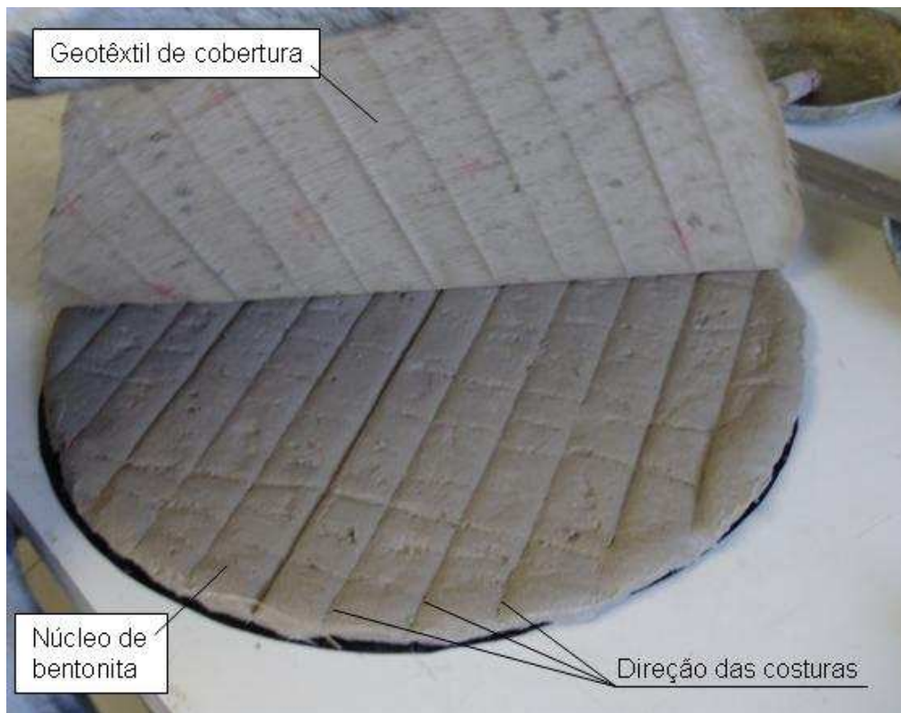
Figura 6.5 – Separação das camadas do GCL para visualização do núcleo de bentonita: corpo de prova 10 (GCL 1.CA com 134% de umidade gravimétrica).
