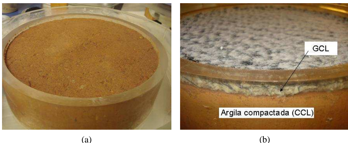
Figura 7.3 – Preparação do cilindro inferior : (a) superfície da argila compactada; (b) GCL instalado sobre a argila compactada
