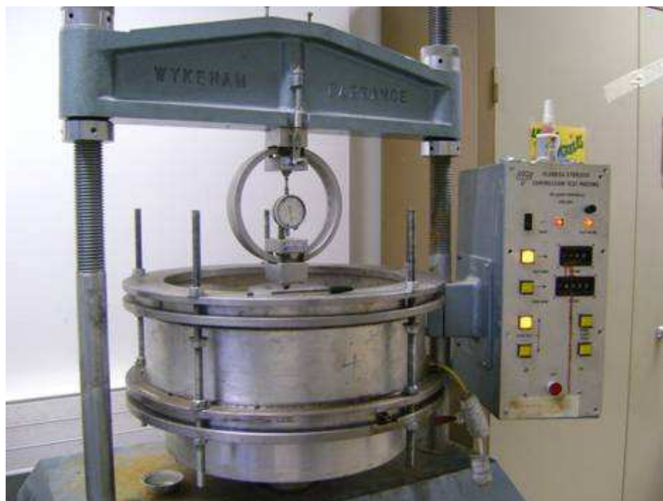
Figura 5.2 – Célula do permeâmetro de fluxo transiente.
