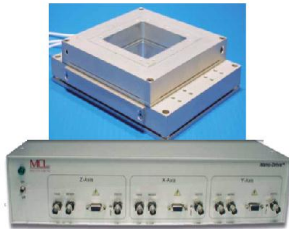
Figure IV.4 : Elément piézoélectrique composé de deux parties.
