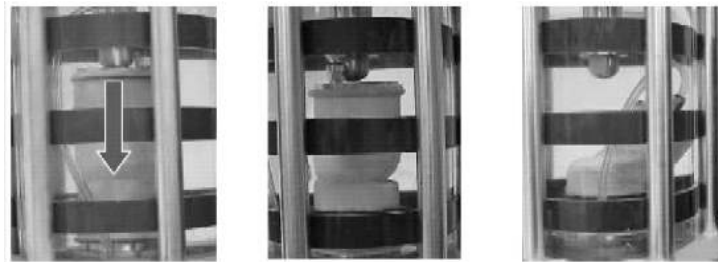
Figure II-23 : Essai de suffusion interne avec un triaxial (Marot et al., 2009).
