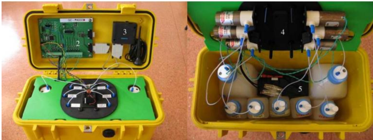
Figure 1.3 : (Gauche) Vue de l'analyseur montrant l'emplacement du laboratoire sur puce microfluidique (1), le panneau de contrôle (2), un modem GSM (3). (À droite) Vue de la pompe (4), la batterie et les stockages de produits chimiques (5) [Slater et al., 2010].
