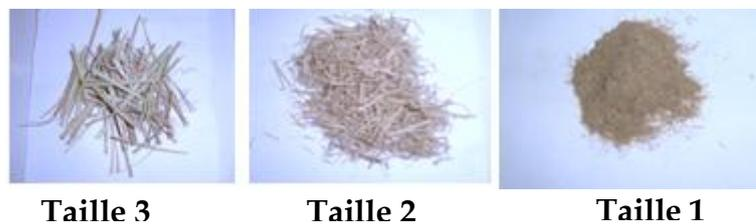
*Fig. 34 : Les différentes tailles de fibres*
