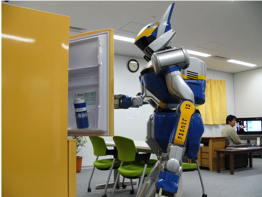
FIGURE 1.3 – Le robot HRP-2 réalisant une tâche de manipulation.
