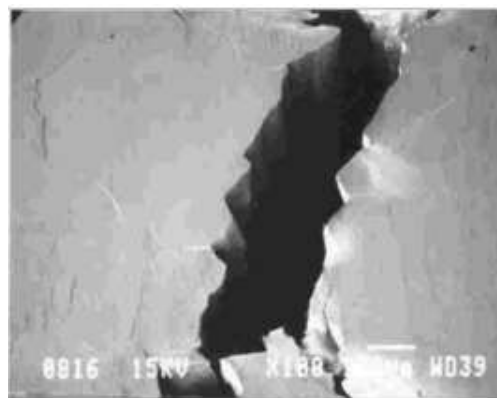
FIGURE 3 – L'image ci-contre, de l'alliage Inconel 52 sollicité en traction lente à chaud ( 600^{\circ}\text{C} , \dot{\epsilon}=10^{-7} \text{ s}^{-1} ) montre une large fissure intergranulaire après seulement 2% de déformation plastique. Les contours des grains en surface sont révélés par le glissement intergranulaire, que nous souhaitons quantifier bien avant la formation des fissures.
