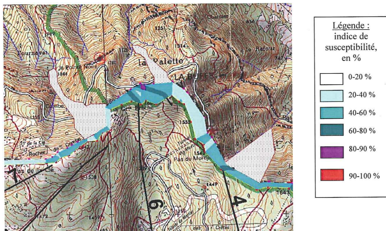
Figure II.D-2. Application de la méthodologie SIG à l'extrémité nord du Vercors, du Mortier à la Combe Noire. Les trois paramètres, pente, hauteur de falaise et proximité à une faille, sont affectés d'un facteur 1/3.
