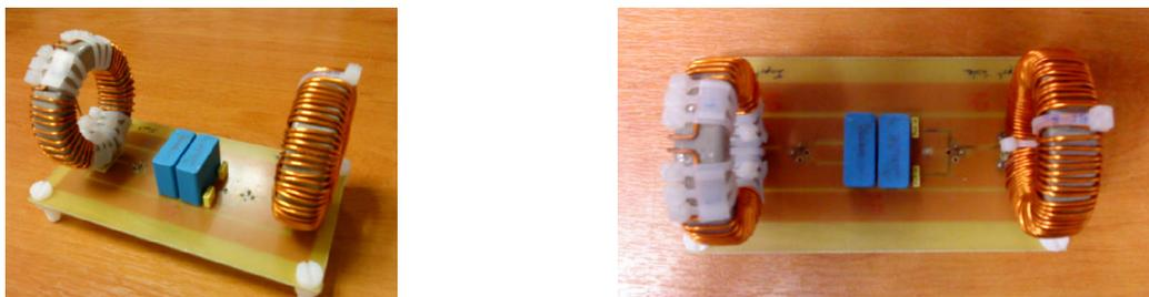
Figure III.41 : Filtre CEM réel
