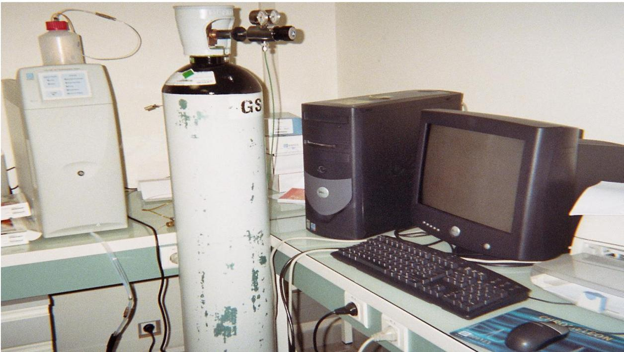
Figure II- 4. Photographie du système de la chromatographie ionique DIONEX
