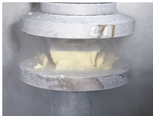
Figure III 12: Eprouvette testée à -170°C, à la fin du domaine élastique.
