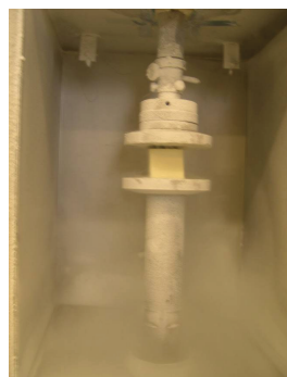
Figure III 24: Enceinte thermique allant jusqu'à -170^{\circ}\text{C} , et disposition d'une éprouvette.
