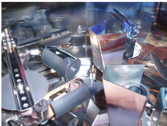
Figure 2 : Photographie de l'intérieur de l'évaporateur Boc Edwards Auto500. Sur la gauche, on peut voir les deux sources à effet Joule classiques, sur la droite les sources contrôlées en température.
