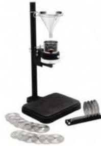
Figure II-13 : Test de coulabilité Flodex
