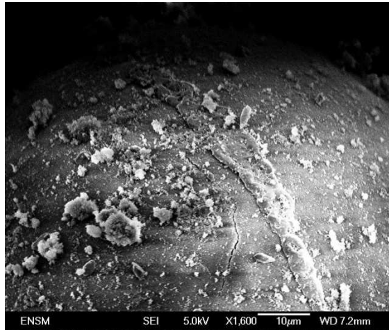
Figure II-36 : Image MEB FEG de la surface externe d'un granule de silice Z1165MP
