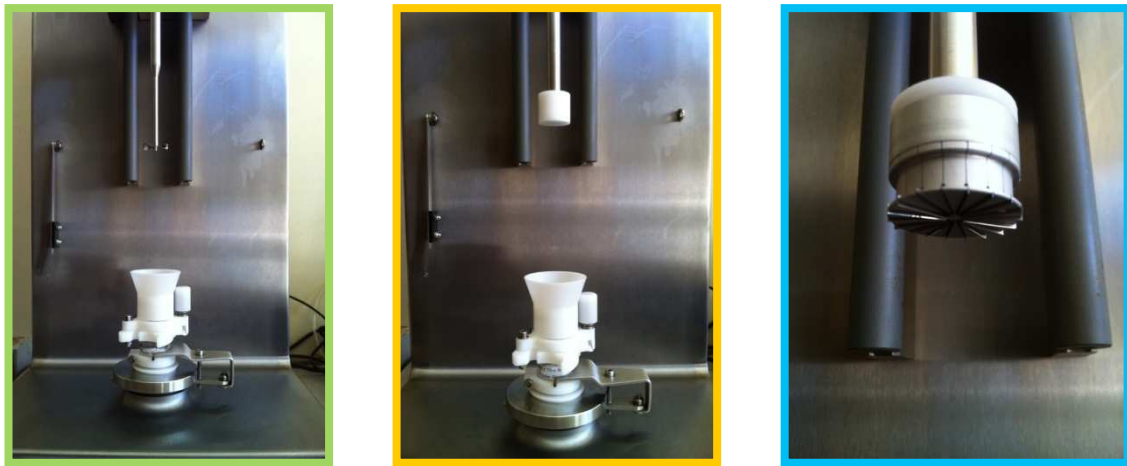
Figure II-11 : Hélice, piston plat, et piston dentelés utilisés lors des tests avec le rhéomètre FT4
