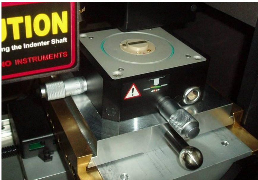
Figure 47 Échantillon monté sur son plot dans la platine d'inclinaison.
