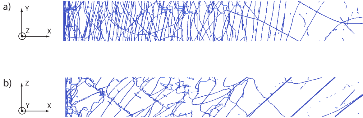
FIGURE III.6 – Allure de la microstructure de dislocations obtenue après une déformation en cisaillement de 0.28% (simulation « B4 modèle EF »). Les dislocations sont à l'équilibre dans des empilements tridimensionnels complexes qui prennent leur source sur le joint. (a) Vue selon l'axe \bar{Z} . (b) Vue selon l'axe \tilde{Y}
