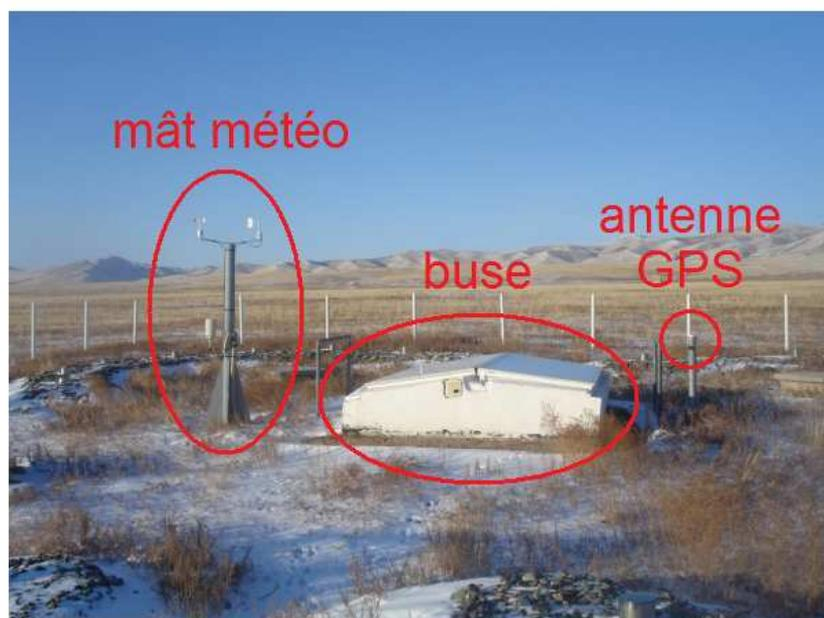
FIGURE 3.5 – Vue extérieure de la zone de mesure du point de mesure I34H1.
