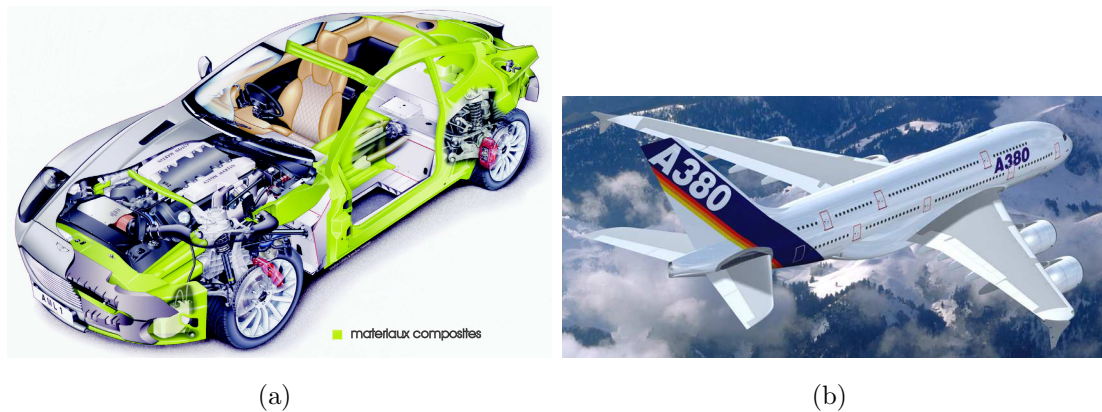
Figure 1.1 – Exemple d'utilisation de composite GD, (a) Aston Martin V12 (Plastics (2002c)) et HP, (b) Airbus A380.
