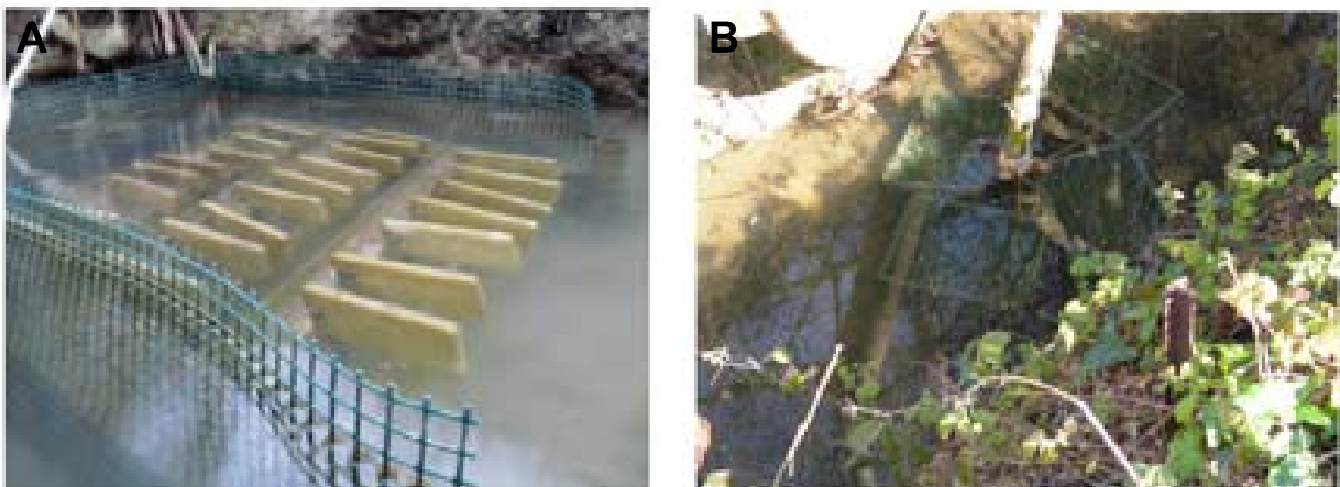
Figure 27 – Dispositifs de collecte de biofilms phototrophes in situ avec les plaques en polyéthylène (A), avec les lames de verre (B), maintenues dans la colonne d'eau ici du site M
