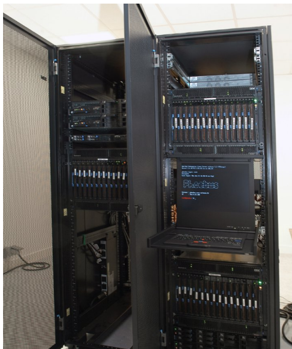
FIGURE 4.5 – Photographie illustrant la machine de calcul, on peut voir les lames encastées dans leur châssis. Image issue de la présentation de F. Loulergue lors des Journées Informatique de la Région Centre (JIRC) 2009.
