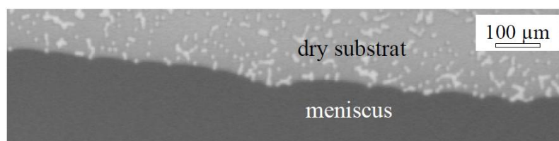
FIGURE 1.4 – Image obtenue par une caméra CCD de la ligne de contact de l'eau sur un substrat désordonné réalisé à partir de défauts de chrome (de taille 10 \times 10 \mu m ) déposés sur une plaque de verre, et apparaissant en clair sur la partie sèche [7].
