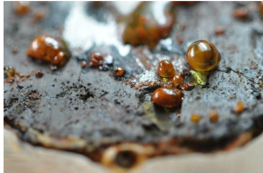
Figure 1 : Formation de gouttelettes de produits de corrosion formées à la surface d'un objet archéologique remis à l'air (lingot de fer), site des Saintes Maries de la Mer [7]
