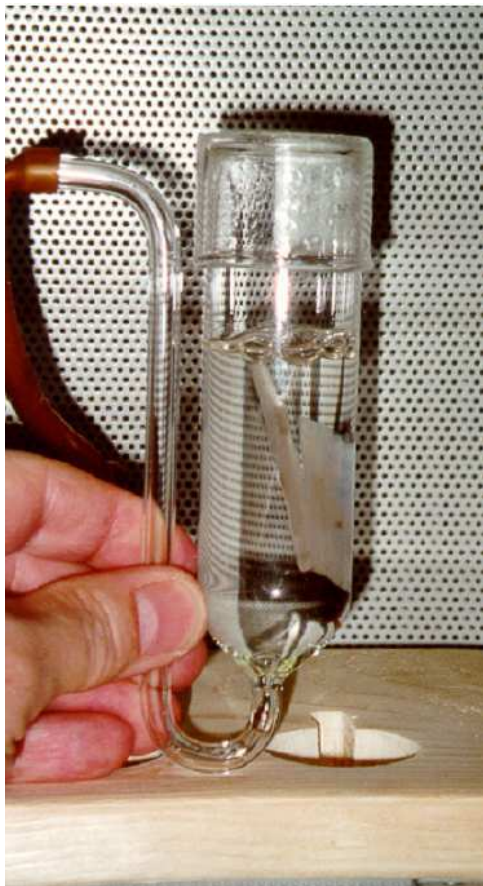
Figure 7 : Microcosme utilisé pour la culture d'hyphomycètes aquatiques. L'extrémité est reliée à une pompe à air permettant une aération et une agitation constante sous l'effet du bullage. Dans le corps du microcosme sont placés du milieu liquide nutritif ainsi que du substrat (rondelles ou gélose).
