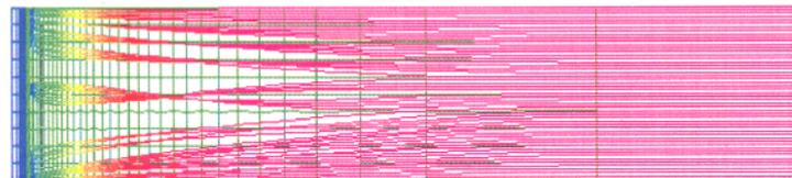
FIGURE 3.7 – Simulation dans laquelle le dépôt d'énergie laser est évalué selon le calcul du tracé des rayons. Le couplage aux perturbations imprimées dans la détente commence et le dépôt d'énergie résultant ne se fait plus sur toute la hauteur. La couleur locale des rayons indique l'énergie restant à déposer : en bleu, tout a été déposé et en magenta, tout reste à déposer.
