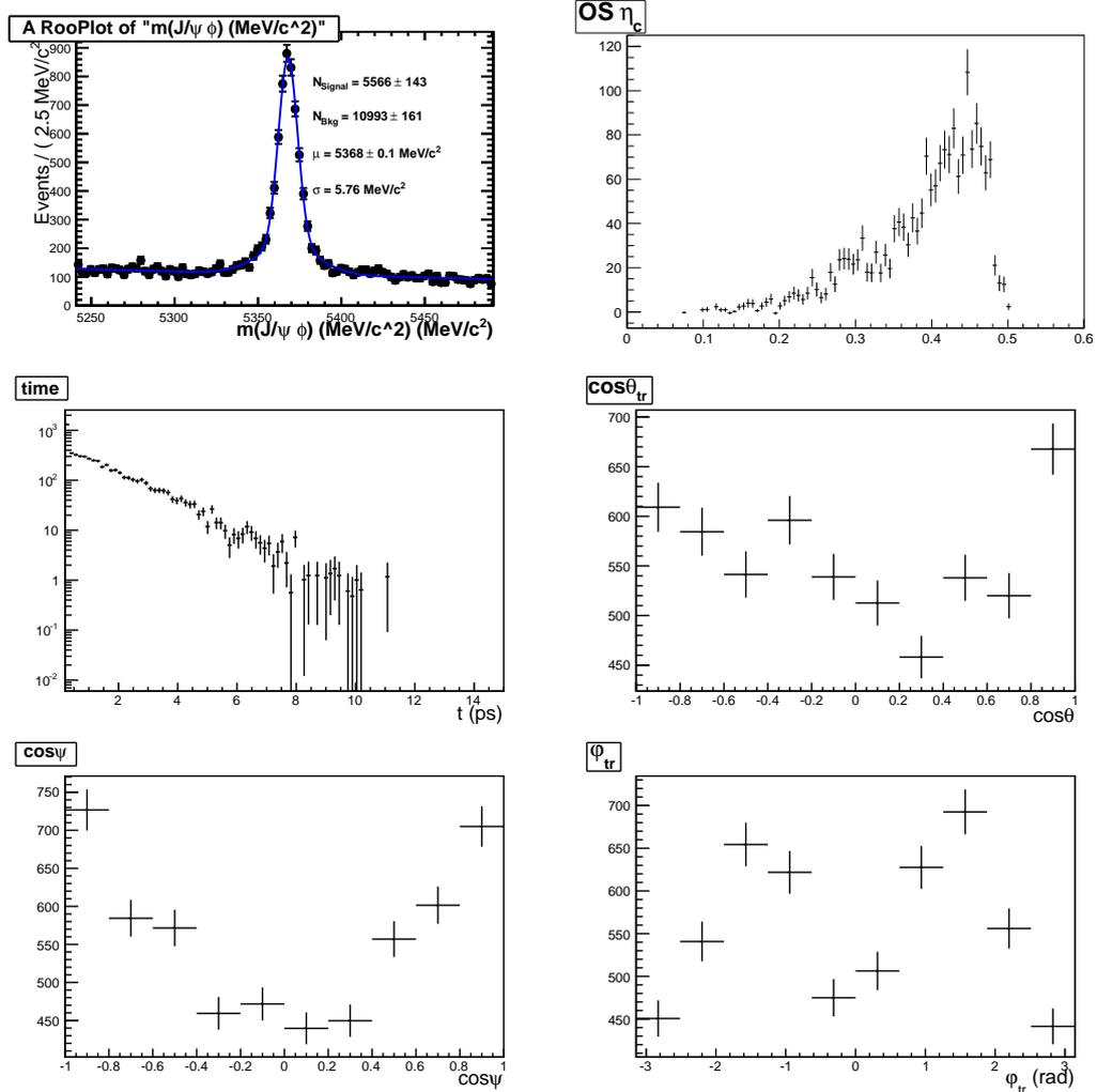
FIGURE 4.12: Distributions de masse, fraction de mauvais étiquetage par évènement ( $\text{OS } \eta_c$  définie dans la section 6, temps propre, ainsi que des angles  $\cos\theta$ ,  $\phi$ ,  $\cos\psi$  pour les candidats  $B_s^0 \rightarrow J/\psi\phi$  ajoutés par la sélection multivariée.
