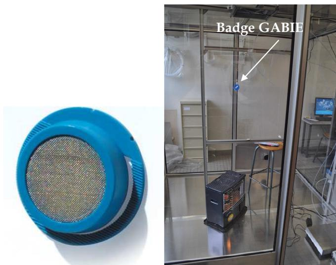
Figure 33. Badge G.A.B.I.E.<sup>TM</sup> et son positionnement par rapport au poêle à mèche lors du prélèvement.
