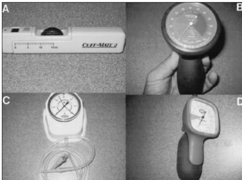
**Figure 30. Manomètres manuels pour mesurer la  $P_{bal}$  (Référence 281).**
