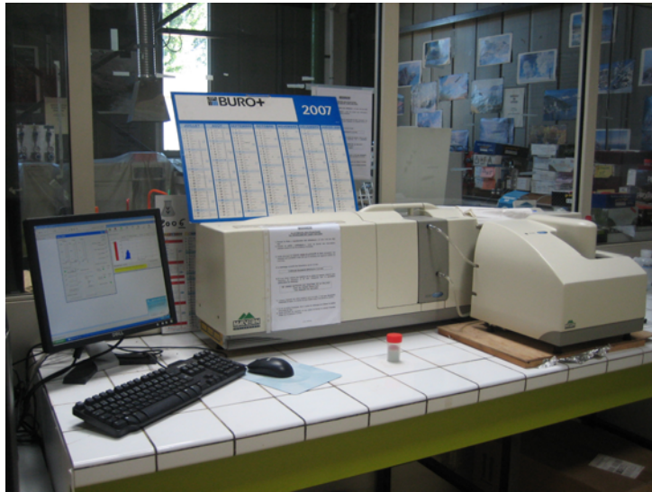
FIG. 4.21 – Photo de la machine de granulométrie laser "Mastersizer 2000"
