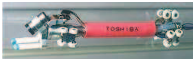
Figure 1.35. : Minirobot d'inspection Toshiba
