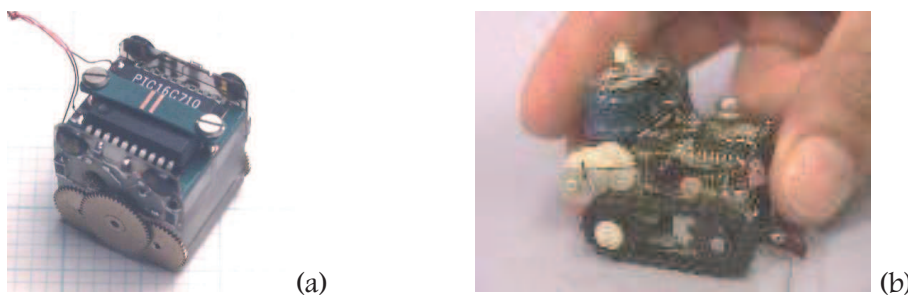
Figure 1.21. : Microrobots à roues Jemmy (a) [NICO-97] et à chenilles The Ant (b) (MIT)
