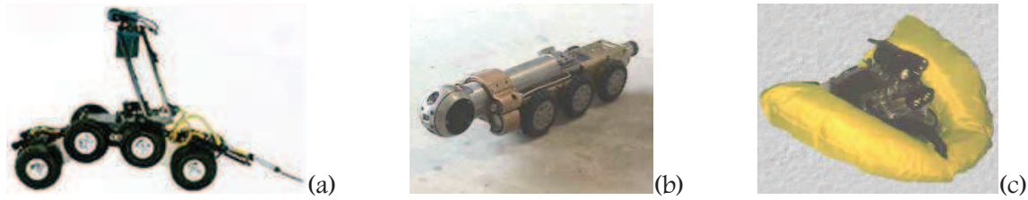
Figure 1.2. : Différents robots industriels d'exploration de tubes de gros diamètre : (a) [CUES-01], (b) [R&RV-01], (c) [R&RV-01]
