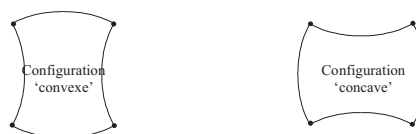
Figure 3.18. : Les deux configurations pouvant être obtenues suivant le sens de l'effort d'amorce
