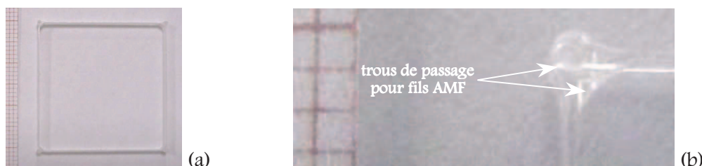
Figure 4.7. : Cadre flexible usiné dans une plaque de Makrolon (a) et détail des perçages pour le passage des fils AMF au voisinage des pivots (b)
