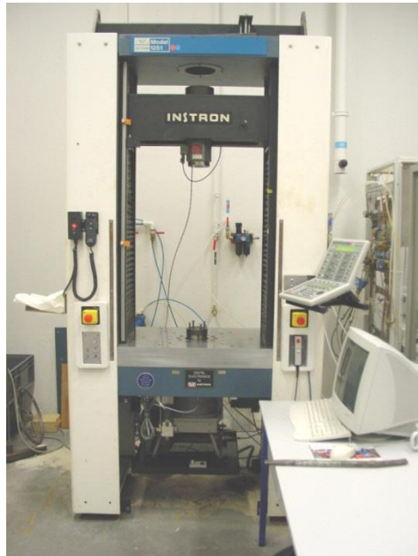
Figure 3-19 : Machine de fatigue INSTRON 1251
