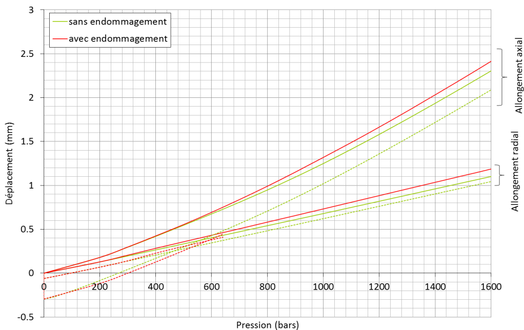
Figure 4-9 : Comparaison de l'allongement radial et de l'allongement axial du réservoir avec et sans endommagement matriciel à -40°C (en trait plein : sans prise en compte de la dilatation, en pointillés : avec prise en compte de la dilatation).
