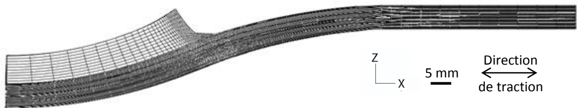
Figure 3-16 : Déformée (x100) d'une éprouvette représentative dont la partie polymère et la partie composite ont été collées.
