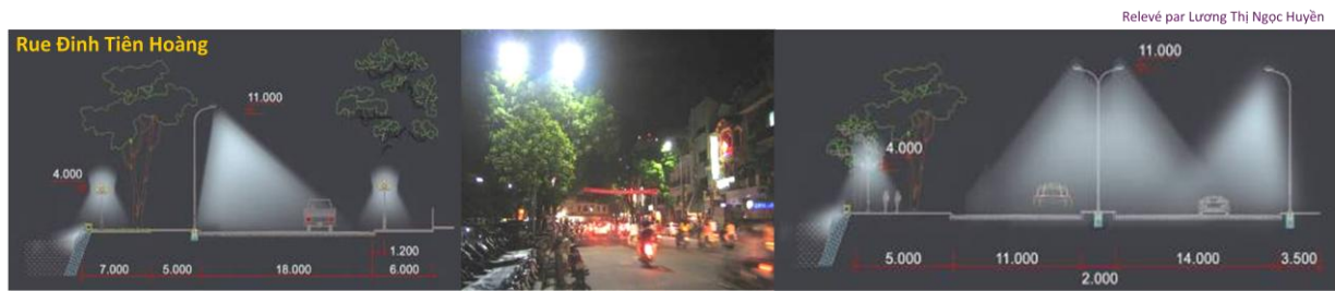
Figure 13 : Quelques types d'installation de l'éclairage des rues à Hà-Nội
