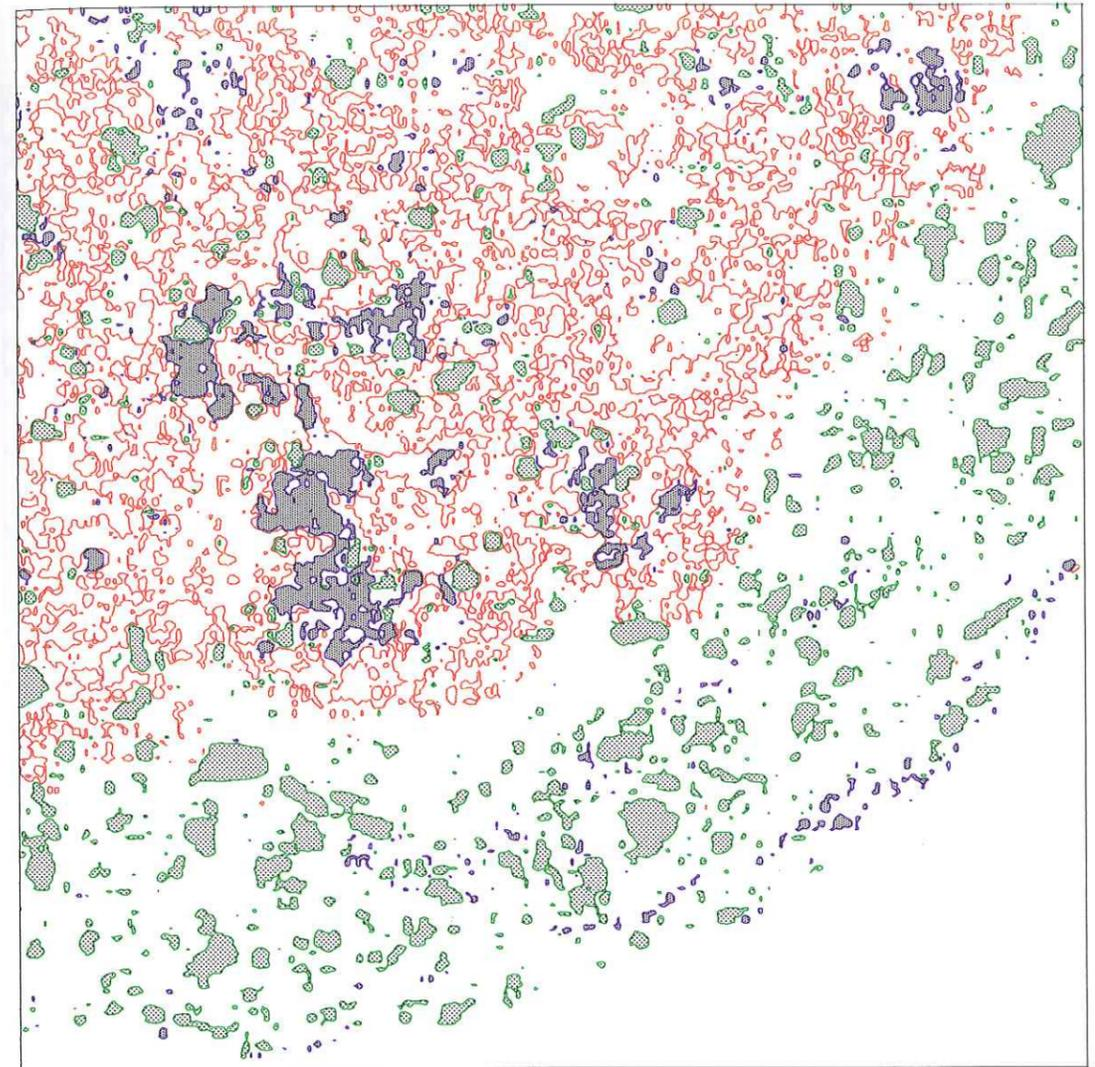
Figure 4-3 : Carte de répartition du manganèse, du fer et du silicium dans le grain n°1 de TN4.
