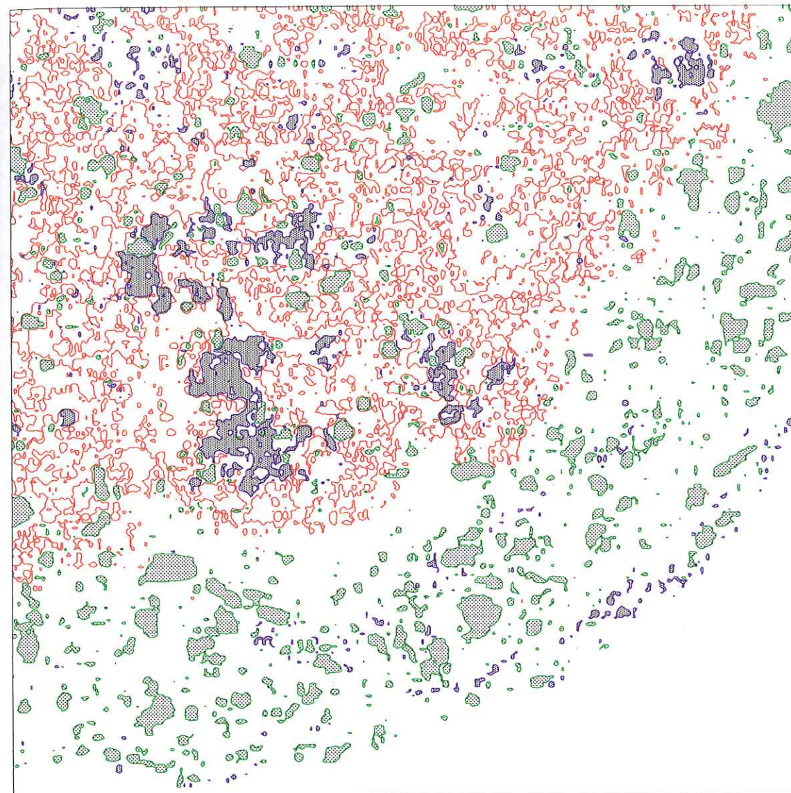
Figure 4-3 : Carte de répartition du manganèse, du fer et du silicium dans le grain n°1 de TN4. Mn>100 : traits bleus + hachures gris-foncé Fe>100 : traits rouges Si>100 : traits verts + hachures gris-clair. échelle : 1 cm = 38 microns
