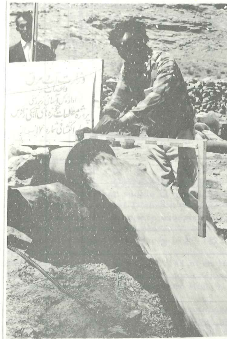
Photo n° 11 - Essai de débit sur le puits n° 3 en bordure de la montagne de Darak, dans les calcaires Asmari-Djahrom -
