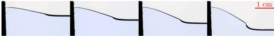
FIGURE 4.5: Quatre images correspondant à des configurations d'équilibre pour une lamelle en Mylar fin, de longueur  $L = 21.0$  mm, pour quatre valeurs différentes de  $H$ . De la gauche vers la droite  $H = 5.0$  mm, 7.2 mm, 8.9 mm et 12.5 mm. Le trait rouge représente 10 mm.
