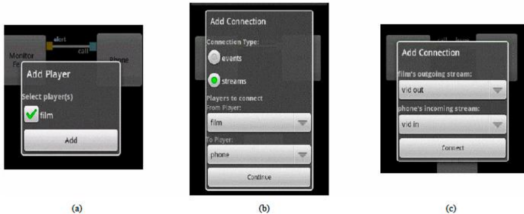
Figure III-18. (a) Ajout de l'acteur film à la configuration de la figure III-16. (b) Ajout d'une connexion de type stream entre film et phone . (c) Désignation des noms des ports de sortie ( vid out ) et d'entrée ( vid in ) de la connexion entre film et phone .
