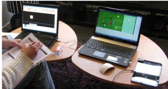
Figure IV-15. KISS expérimental. Sur la table de gauche, le laptop sur lequel s'exécute l'éditeur de programmes. Sur la table de droite, le laptop du metteur au point et sa tablette pour jouer sur le temps.
