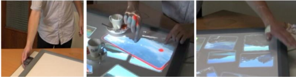
Méta-IHM-réflexe (à gauche) : Lancement de Photo-Browser en mettant le smartphone en contact avec la table Application Photo-Browser (centre) : Tri des photos sur la table Méta-IHM-réflexe (à droite) : Arrêt de la table par un geste de balayage couvrant la table
