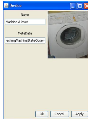
Figure IV-30. Ajout dans la base de données de IconicGen de la représentation iconique du dispositif Machine à laver métadécrit par le nom de classe washingMachineStateObservable issu de la BdC.
