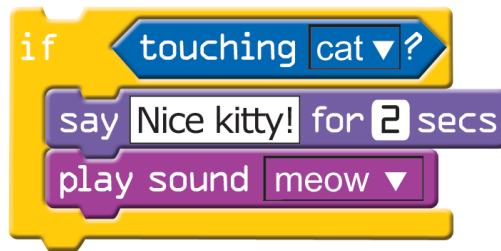
Figure III-7. Un exemple de programme en langage Scratch. Chaque instruction « if » usuelle est augmentée de marqueurs graphiques pour indiquer sa nature et sa portée. L'entête de cette instruction dispose d'un emplacement pour accueillir une valeur booléenne représentée graphiquement par un hexagone, son corps accueille d'autres instructions assemblées telles des pièces de puzzle. Ce programme signifie : si le chat est touché, dire « Nice kitty ! » pendant deux secondes, puis jouer le son meow (miaulement).
