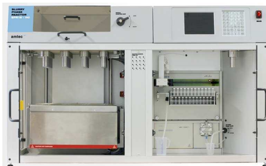
Figure 14 : « Parallel Slurry Phase Reactor » (SPR16)
